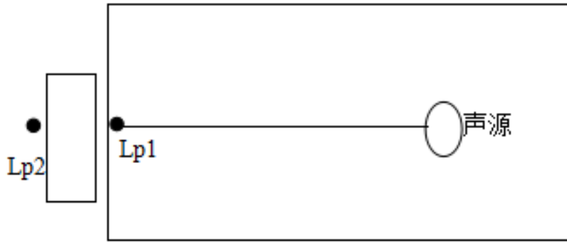
图 9 室内声源等效为室外声源图例
