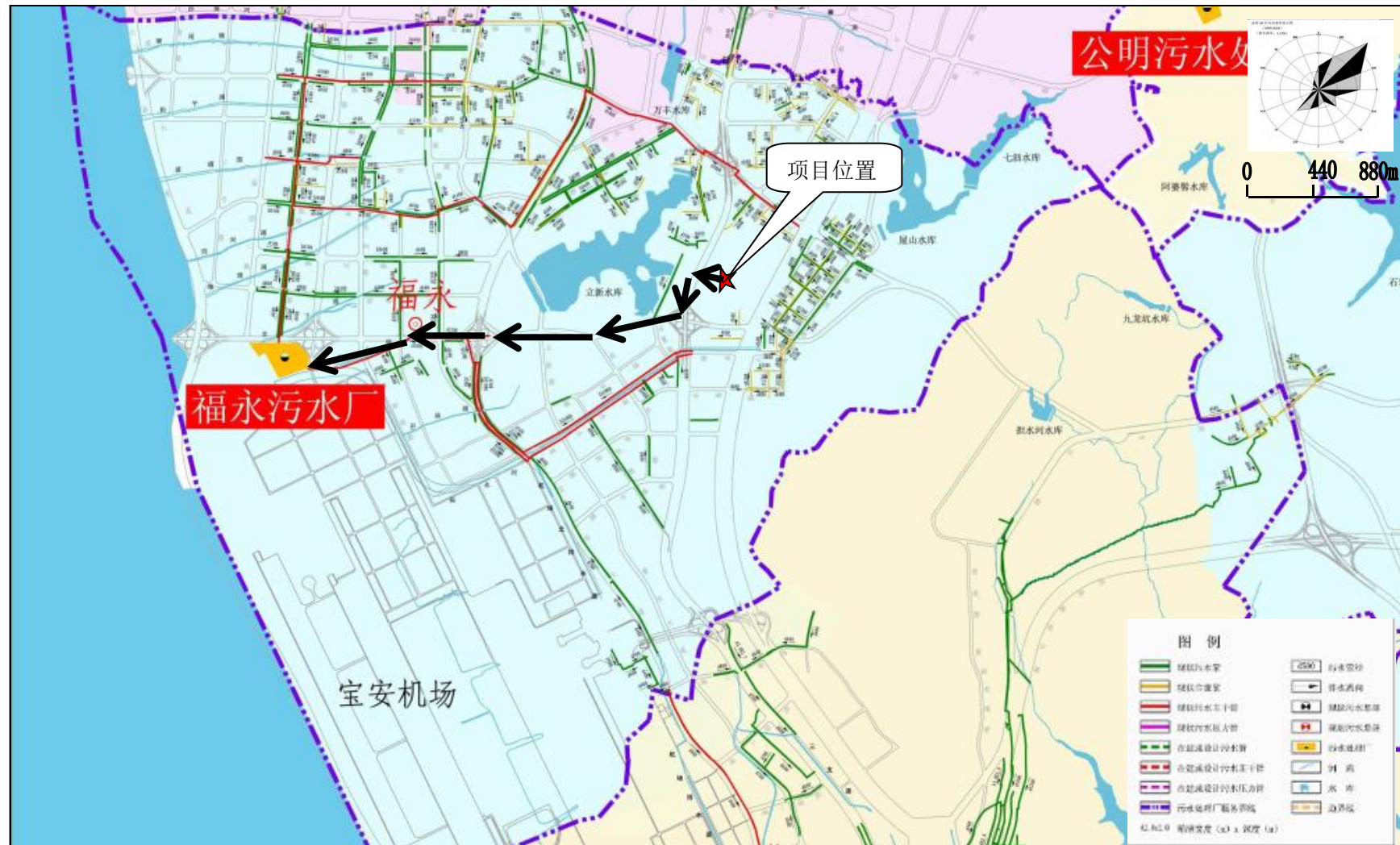
附图 7：项目所在区域污水管网图
