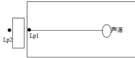
图 7 室内声源等效为室外声源图例
